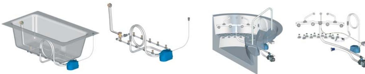
Podemos oferecer-lhe um completo sistema de jets de ar, eletrônica, iluminação e desinfecção para spas e banheiras de hidromassagem.
