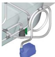
Para evitar retorno de água para o compressor, instalar sempre um pescoço de cavalo e uma válvula anti retorno do lado da tubagem da água.
