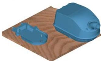
Abra o fundo do compressor, desaperte os dois parafusos na parte de trás, monte a parte inferior do compressor na "Estrutura de montagem" com parafusos através da borracha do corpo inferior. Aperte os parafusos.
